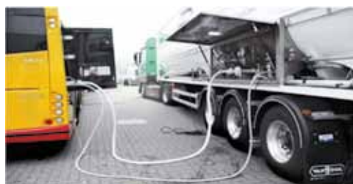
Rysunek 21. Tankowanie autobusu LNG Solbus Solcity SM18 z mobilnej stacji tankowania Gazprom Germania
